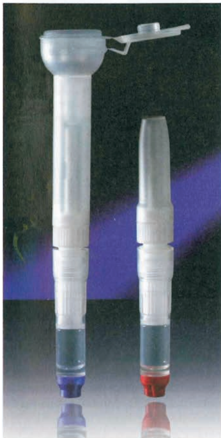
Bild 1. Das Messgerät HY-LiTE als Oberflächen- test mit Probegefäß (links) und als Flüssigkeits- test mit Schutzkappe (rechts). Der Probenstift nimmt ein definiertes Probevolumen auf und überführt die Probe in die Küvette. Dort wird das Probenmaterial verdünnt, neutralisiert und gepuffert. In der Reagenzkammer wird dann mit einem Luziferin/Luziferase-Gemisch der ATP-Gehalt bestimmt
