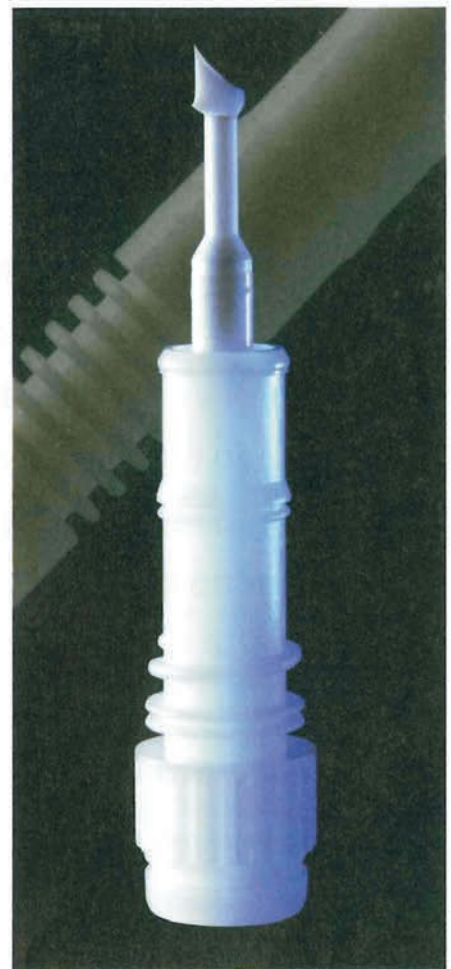
Bild 2. Der Probenstift ist mit einem Extraktant zur Freisetzung von ATP aus zellulärem Probenmaterial beschichtet
